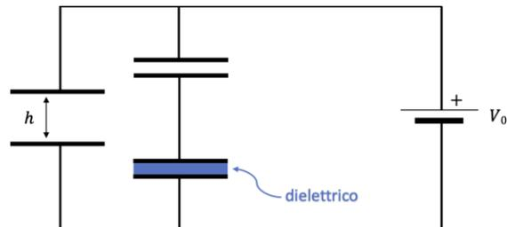
Un circuito contiene tre condensatori piani disposti come in due armature quadrate di lato  $L = 20 \text{ cm}$  parallele fra loro.  $L$  di  $h = 5.0 \text{ mm}$  per uno dei condensatori (si veda la figura) ed lastra di materiale dielettrico omogeneo ed isotropo di  $c$  riempie tutto lo spazio fra le armature di uno dei tre generatore che eroga la differenza di potenziale  $V_0 =$  calcolare:
