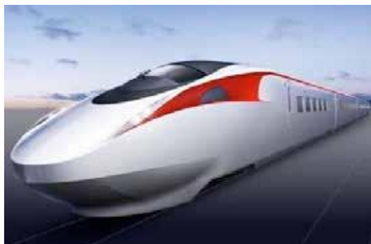
Un treno a levitazione magnetica come questo, grazie ai suoi magneti superconduttori, trasporta i passeggeri a 550 km/h tra la città di Shanghai e il suo aeroporto
